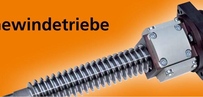
Hydrostatische Gewindetriebe (HGT) überzeugen durch eine geringe Positionsstreu breite, sind hoch belastbar, arbeiten verschleißfrei und sind Linearmotoren zudem durch weit geringere Betriebskosten überlegen. Gute Gründe also, bei Linearantrieben für spanende und umformende Werkzeugmaschinen auf den HGT zu setzen.
